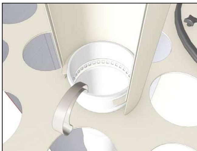
Mise en tension de la manche dans la partie supérieure à l'aide d'un outil pneumatique. Verrouillage de la manche par snap ring.
