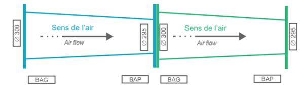
Cette conception en forme de léger "cône" ainsi que l'assemblage engendre moins de frappe d'air ce qui limite l'usure dans le temps.
